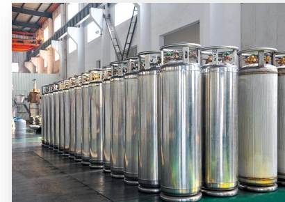
Small LNG cylinders
