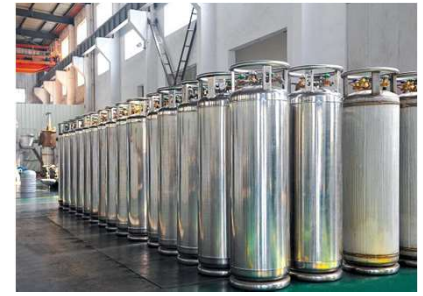
Small LNG cylinders
