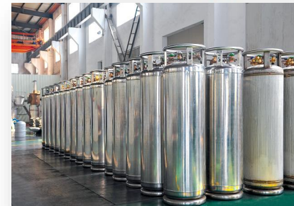
Small LNG cylinders
